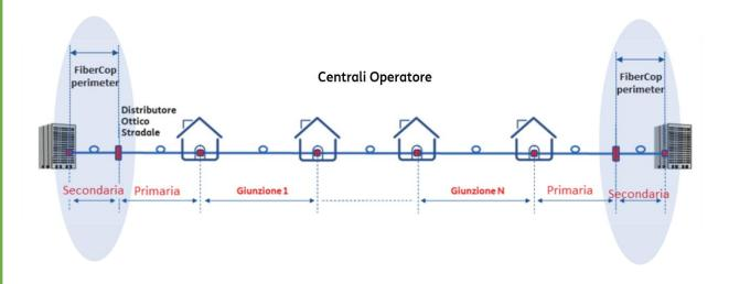
In caso di spazio disponibile, il primo PTO sarà generalmente collocato direttamente all'interno del pozzetto in sede stradale, nei pressi del Centro Nodale Ottico (CNO) o del Cabinet Ripartilinea Ottico (CRO) della rete FTTH di FiberCop. In assenza di spazio disponibile nelle infrastrutture di rete già predisposte (CNO/CRO), il PTO dell'Operatore dovrà essere realizzato allo scopo, secondo le indicazioni che FiberCop fornirà nei casi specifici.
