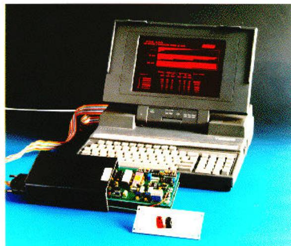
Figura 1a Strumento di misura dei disturbi impulsivi
